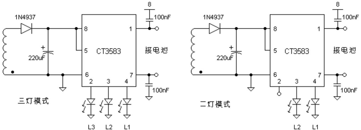
电源指示灯 L1 应选取开启电压为 1.88V-1.93V（在 2mA 电流下测量）的 LED。
