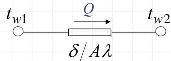
图 导热热阻的图示
