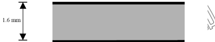
圖 9 鋁基板之通路層與介電材料厚度之示意圖
