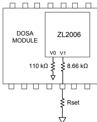
**Figure 13. R<sub>SET</sub> on a DOSA Module**
