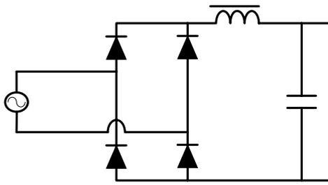
图 3 整流后加 PFC 电感器
