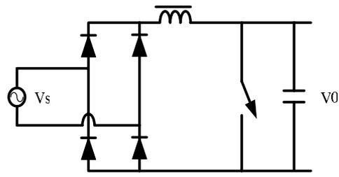
图 4 有源功率因数校正电路
