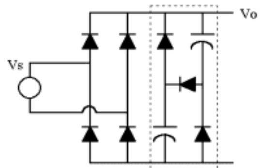
图 2 通过二极管和电容组成的电路加在整流桥后
