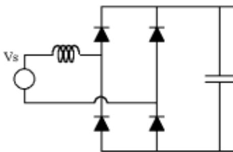
图 1 在整流前加入谐波抑制电感器
