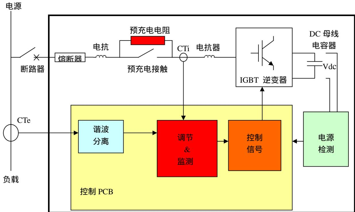
如上图所示，断路器合闸后，APF 首先通过预充电电阻对 DC 母线的电容器充电，这个过程会持续 10 秒钟，防止上电后对 DC 母线电容器的瞬间冲击。当母线电压  $V_{dc}$  到达额定值后，预充电接触器闭合。当 APF 失电时，接触器才会打开。控制板 PCB 通过  $CT_i$  采集负载电流信号，谐波分离模块将其中的基波成分移去后，所得到的谐波成分送到调节和监控模块。该模块有两个功能，一是可以产生调节谐波电流给控制信号模块；二是对系统所有功能进行监测。控制信号模块产生驱动信号触发 IGBT 变换器，向系统反送补偿谐波电流。
