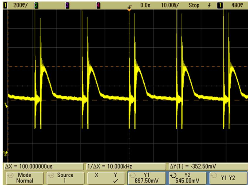
LED 串联 2ohm 电阻的电压波形
