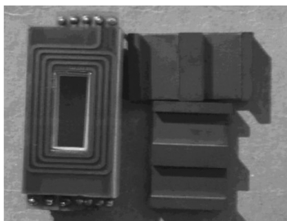
图3. 匝比4:1的实验变压器 Fig.3 Planar transformer under test
