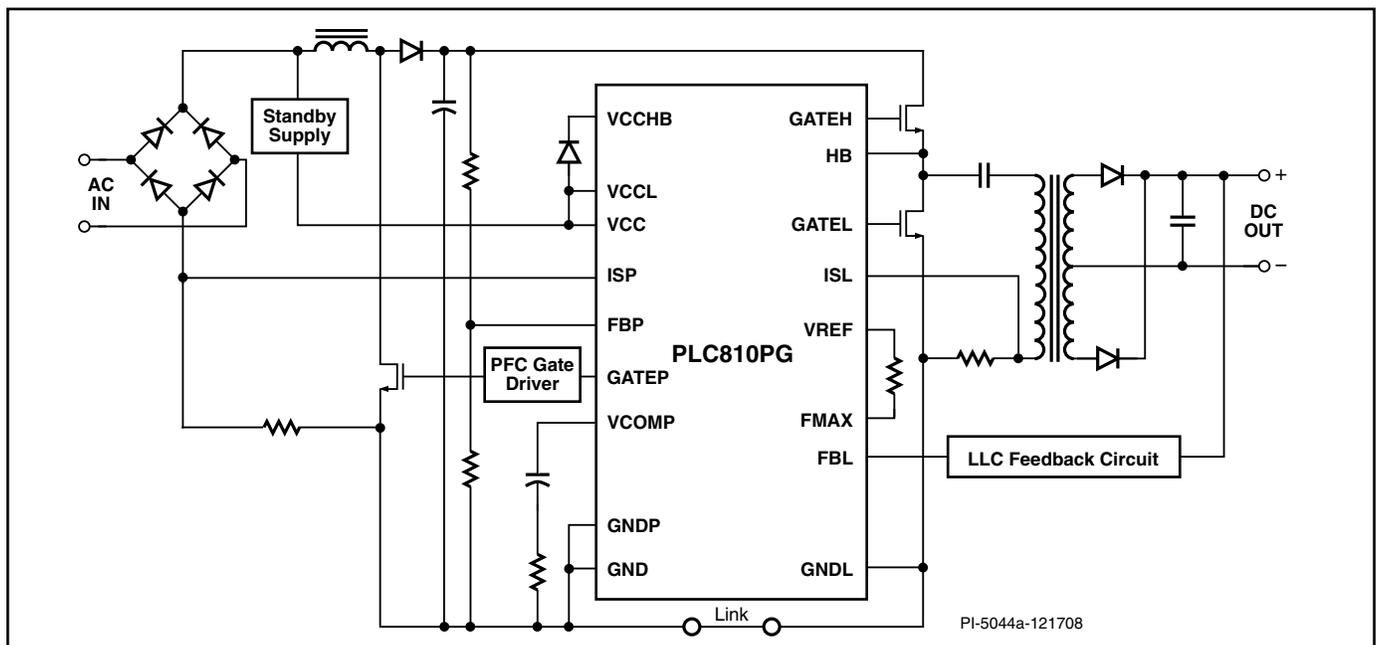
图1. 典型应用电路 — LCD电视机电源
