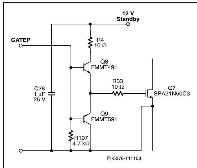
图 13 PFC栅极驱动电路设计建议
