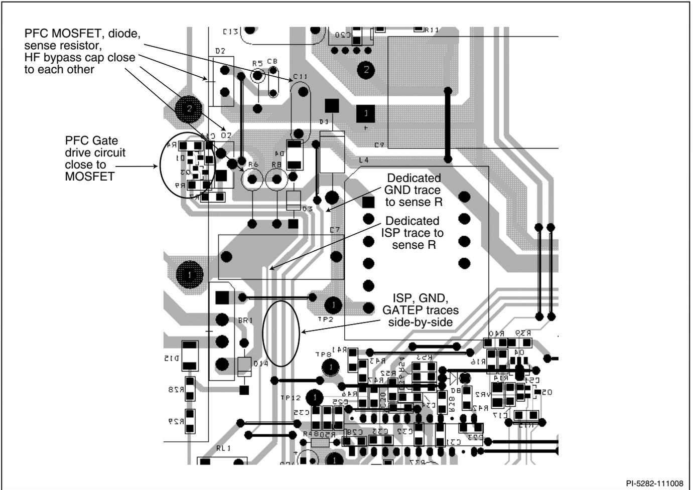
图 12. PFC功率和信号布局设计建议
