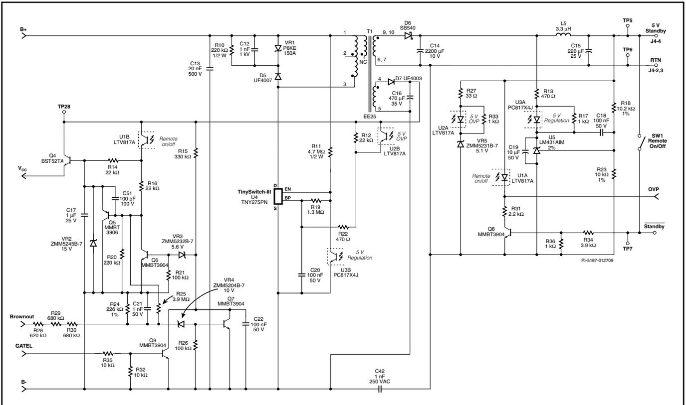
图 6. PLC810PG LCD 电视机电源应用，待机电源
