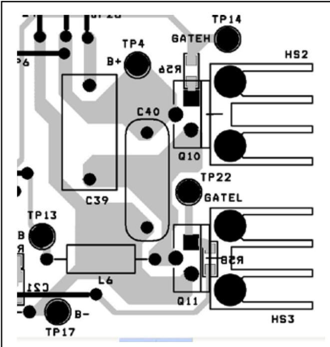
图 9. LLC 高压薄膜退耦电容 C40 的位置
