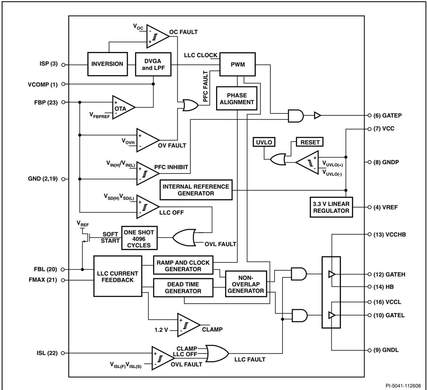
图 3. PLC810PG 结构图。未显示预留的引脚
