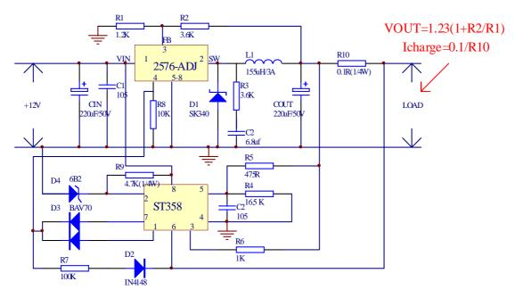
优点: (1) 由于 2576 内置过流保护、过温度保护等安全措施,结合 358 (双运放)来实现输出恒压 CV,恒流 CC,过压保护 OVP 等功能;实现了可靠、安全、完善的锂电池充电方案;
