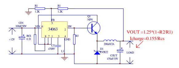
优点: 在[1]方案的基础上扩流来满足不断增长的充电电流能力的需求;
