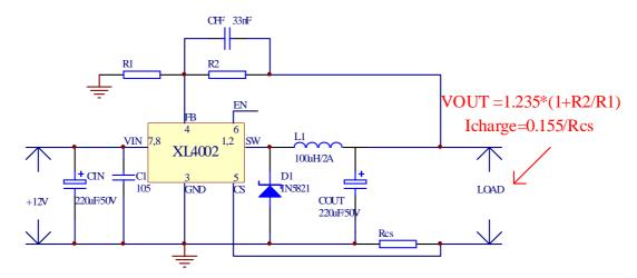
基于车充领域的系统需求,上海芯龙半导体有限公司提供专用于车充方案的系列单片 IC;内部除了常规的过流保护,过温度保护,输出短路保护外,还内置了专用于锂电池充电的 CV, CC, OVP;相当于把[3]方案中的 2576+358+稳压管等功能模块全部集成到一颗 IC 中;
