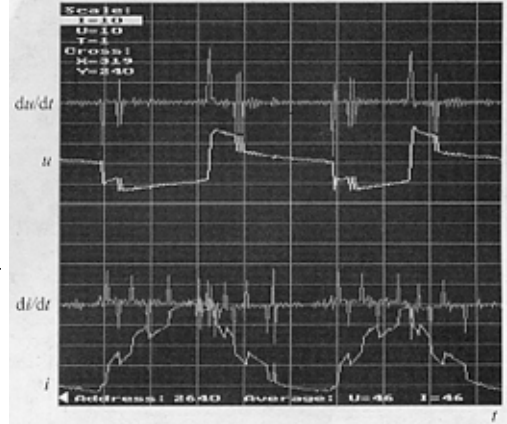
图 1 焊接电流、电压及其微分曲线
