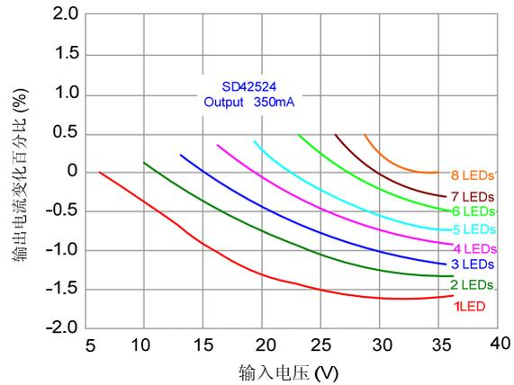
输出 350mA 电流随输入电压变化率
