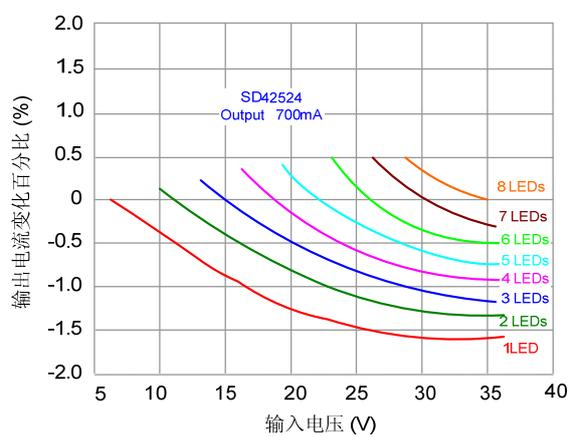
输出 700mA 电流随输入电压变化率
