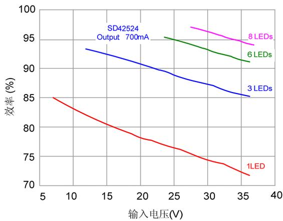
输出 700mA 效率随输入电压变化曲线
