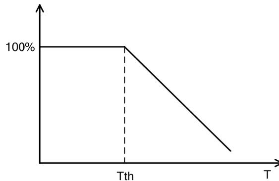
LED 输出电流随温度的关系
