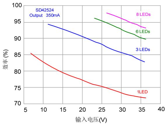
输出 350mA 效率随输入电压变化曲线
