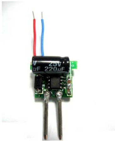
图 3 SD42522_MR16 PCB 板正面
