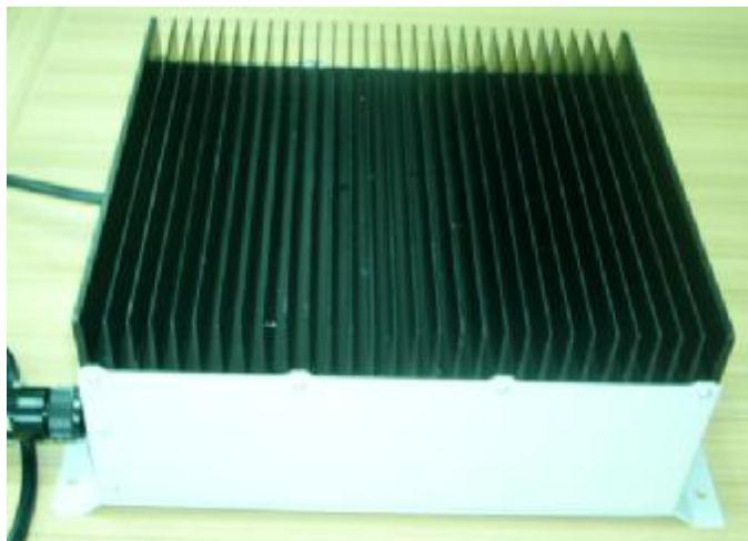
安装方向如图，令散热板垂直向上，两边螺丝孔固定在车上，最好采用一些防震设备。
