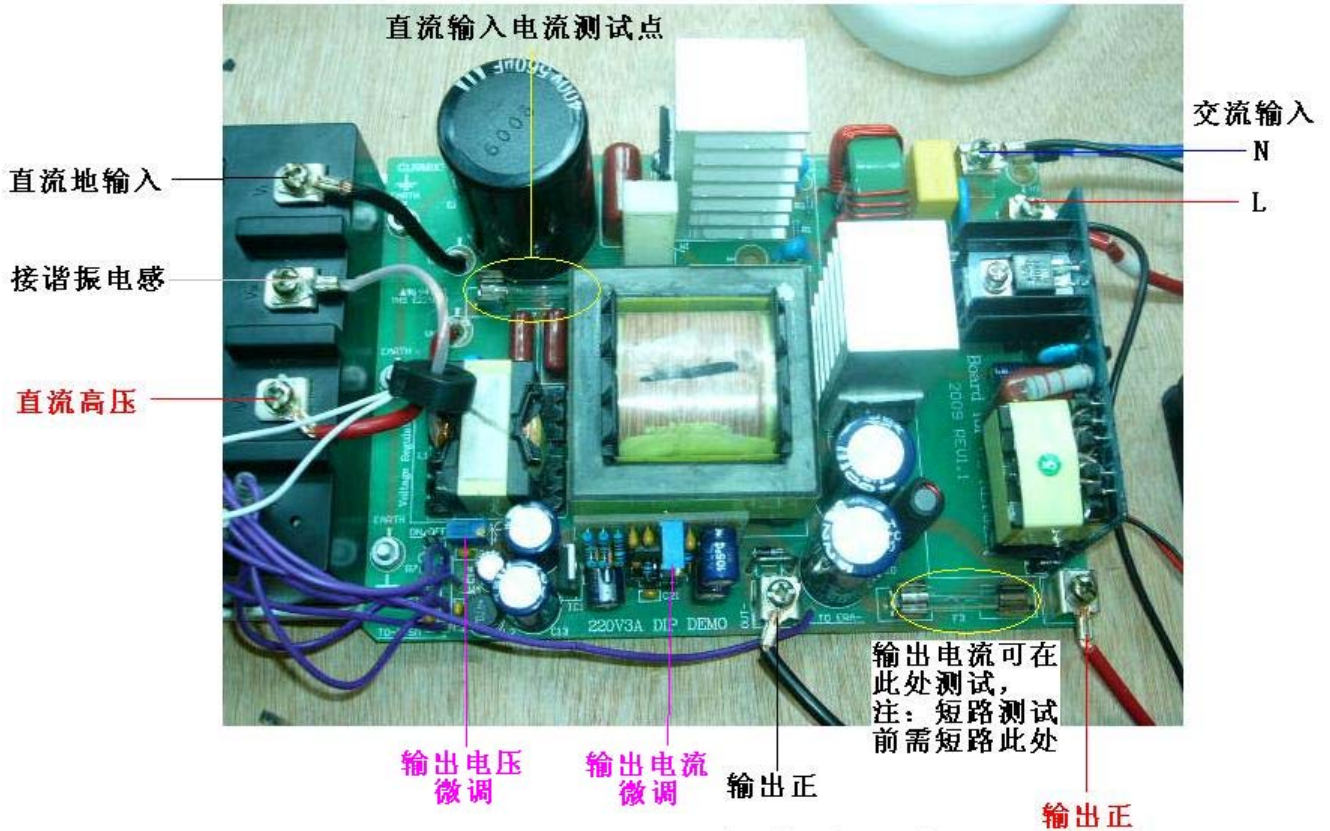
220V3A DEMO板接线示意图
