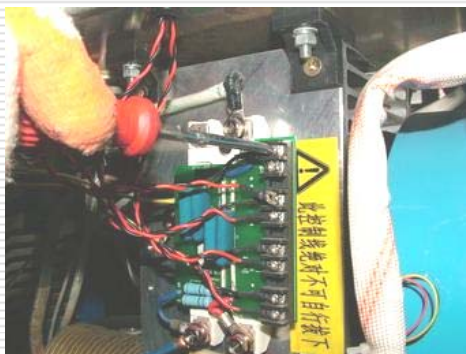
8、用十字形螺丝刀一一对应恢复驱动板控制线
