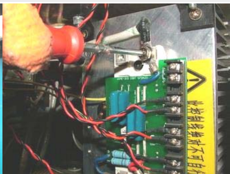
7、用十字形螺丝刀紧固直流母线
