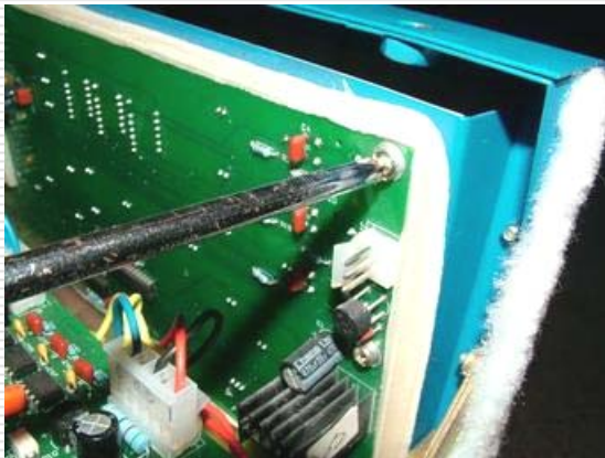
用螺丝刀旋松螺钉，取下显示板。
