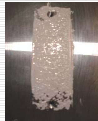
4、用干净的抹布清除散热器的导热硅脂
