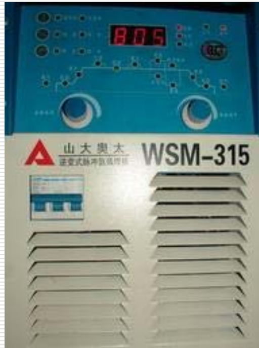
805: 氩弧焊空载时间长 时间按下焊枪开关或者 焊枪开关短路
