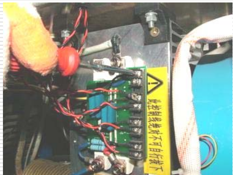
1、用十字形起子拆掉控制线
