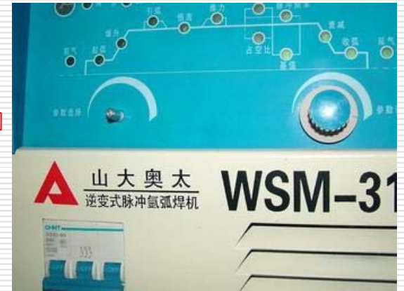
拆掉垫圈,将另一只编码器以同样的方法拆掉旋钮。
