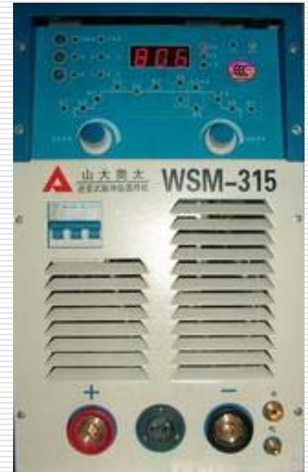
806: 氩弧焊缺水 保护
