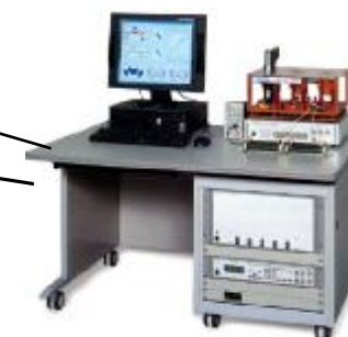
电感损失分析仪 • 升压线圈的评价 • 滤波电抗的评价
