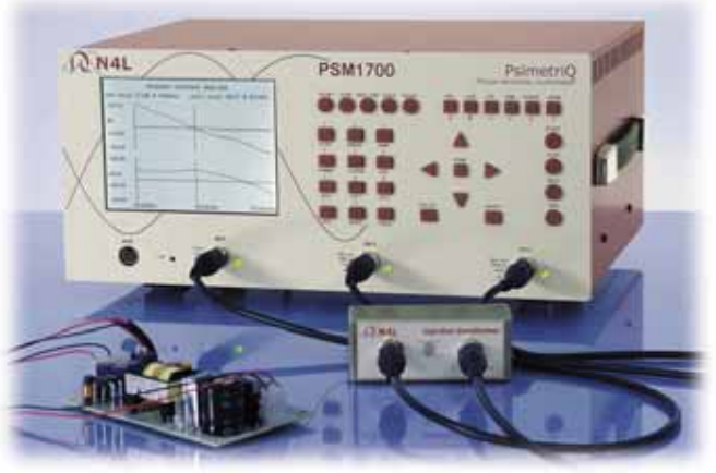
PSM1700 测试开关电源环路特性
