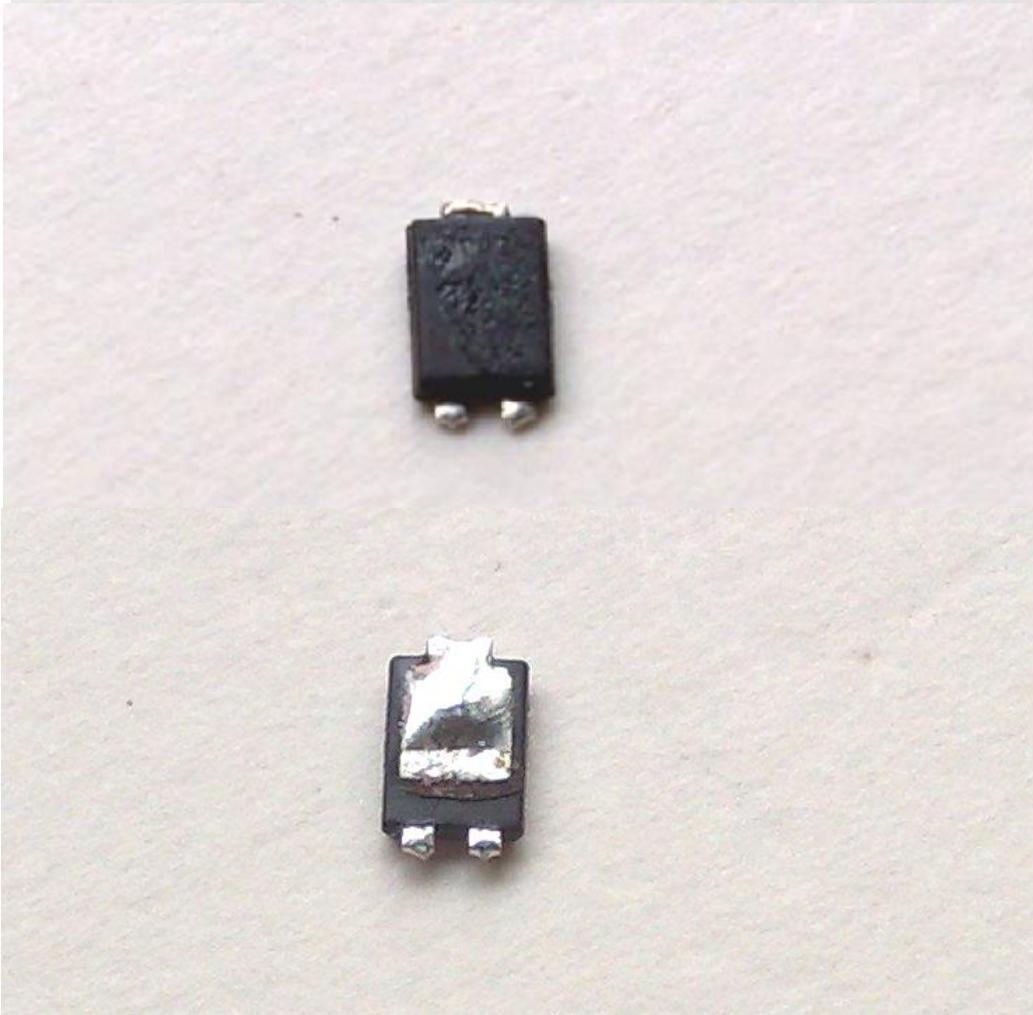
黑色塑胶封装，肖特基二极管，黑色本体尺寸（不含引脚）：长5.3mm宽4mm厚1.2mm
