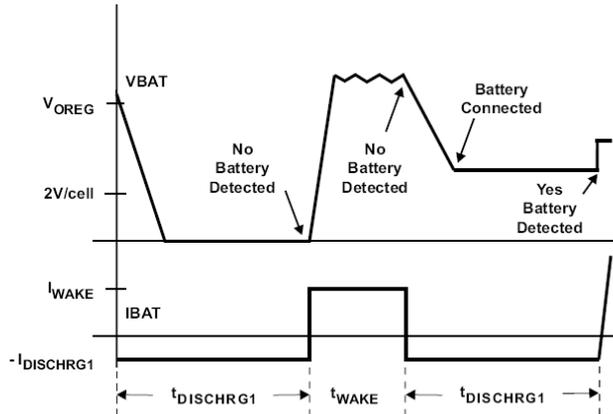
无电池检测的波形如上图所示。t<sub>DISCHRG1</sub> 一般为 1s，t<sub>WAKE</sub> 一般为 0.5s。
