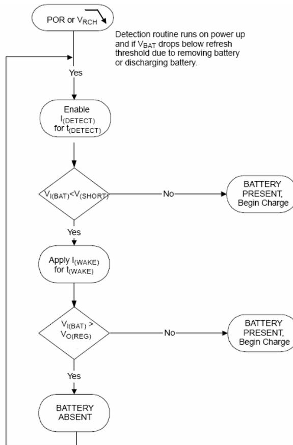
充电完成后，电池电压检测脚的电压保持在再充电阈值电压  $V_{REG}$  以上。由于电池放电或者是电池移除，导致电池电压检测脚的电压低于再充电阈值电压时，HT6298A 启动无电池检测过程，如上图所示。该检测过程，先使能一个周期时间为  $t_{DISCHARGER}$  的检测电流 ( $I_{charger}$ )，并检查电池电压是否低于短路阈值电压 ( $V_{SHORT}$ )。如果电池电压低于  $V_{SHORT}$ ，则说明电池在，启动充电过程，否则，说明电池不在。然后启动下一步检测过程，使能一个周期时间为  $t_{WAKE}$  的唤醒电流 ( $I_{WAKE}$ )，并检查电池电压是否高于再充电阈值电压。如果此时电池电压低于再充电阈值电压，则说明电池在，启动充电过程，否则，说明电池不在，再一次执行无电池检测的第一步。
