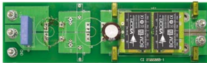
图12 测试I048C480T060P1高电压/低 电流的1/4砖IBC
