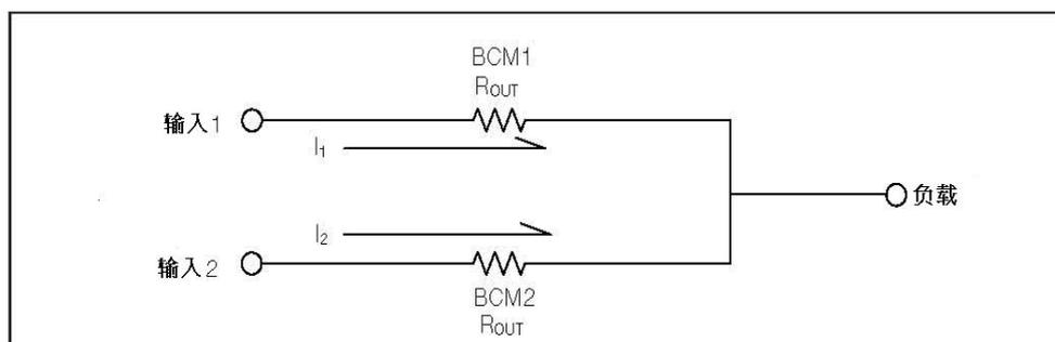
在这个例子中，先假设没有输入和输出阻抗。如果在 $V_{IN1} = V_{IN2}$ 时，通过两个部份的电流便会相等。但举例假设以下数据：
