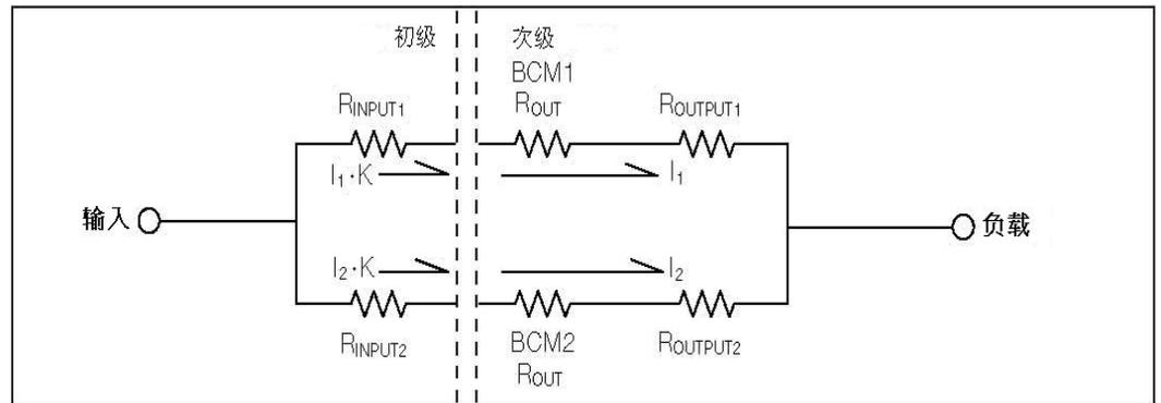
如果 $R_{INPUT1} = R_{INPUT2}$  及  $R_{OUTPUT1} = R_{OUTPUT2}$ ，在两路通过的电流便会相等。当 $R_{OUTPUT1}$ 增加时，相对通过的电流便会正比减少。另一点十分重要的事，当 $R_{INPUT1}$ 增加时， $I_1$ 却以 $K$ 因素的平方而减少。而BCM的 $K$ 因素越细( $\ll 1$ )，输入阻抗匹配的重要性就越轻。举个例子，假设下列的数据：
