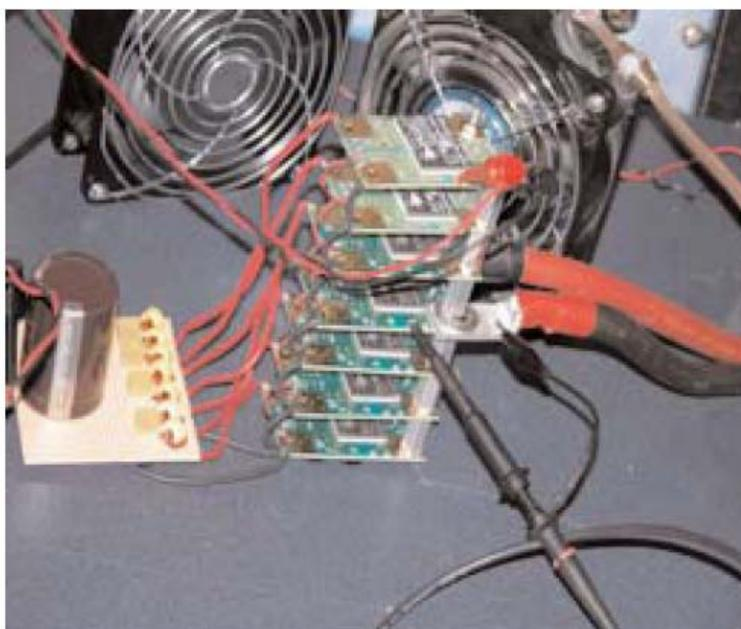
一个更精优的BCM阵列例子是B384F120T30-PB示范板(如图6所示), 384Vdc转为12Vdc, 1200 W。
