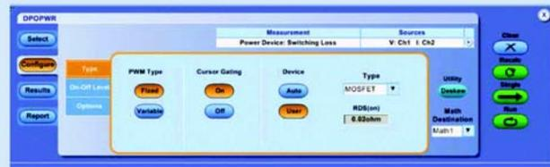
图 7. DPOWPR 输入页面允许用户输入  $R_{DSon}$  和  $V_{CEsat}$  的产品技术资料值。
