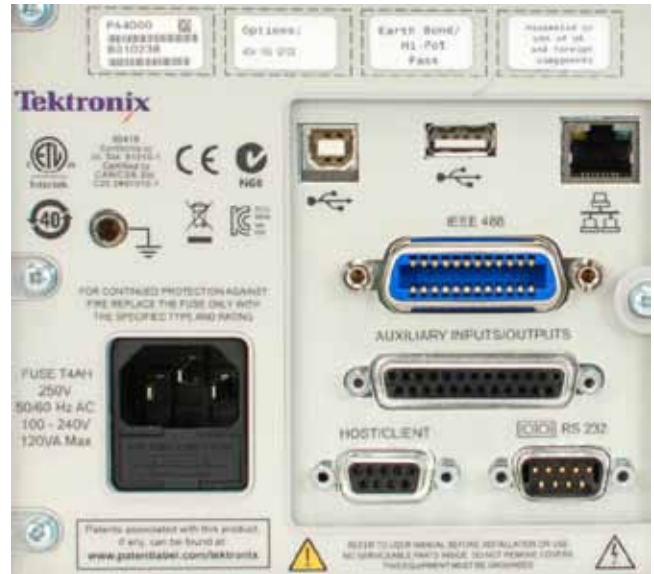
PA4000 后面板，带有多个通信端口
