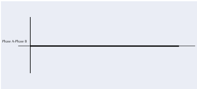
图 4. 所有三相的相同脉冲波形导致零电压。
