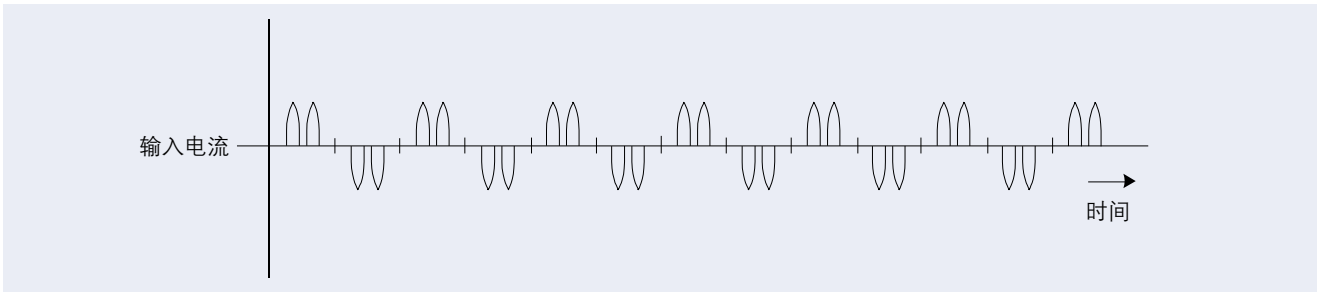
图 19. 未经调制的输入电流波形。
