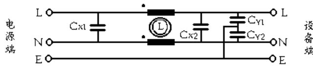
图3-8 电源EMI滤波器
