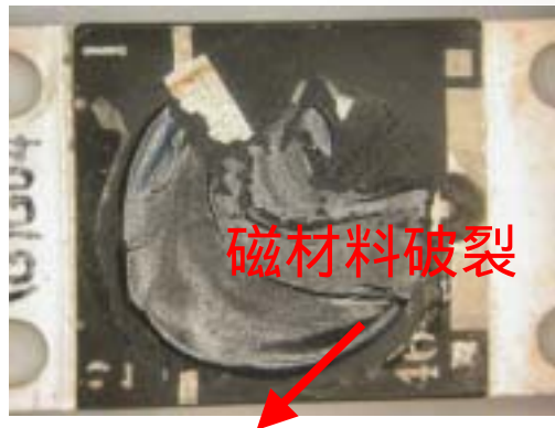
磁性材料断裂
