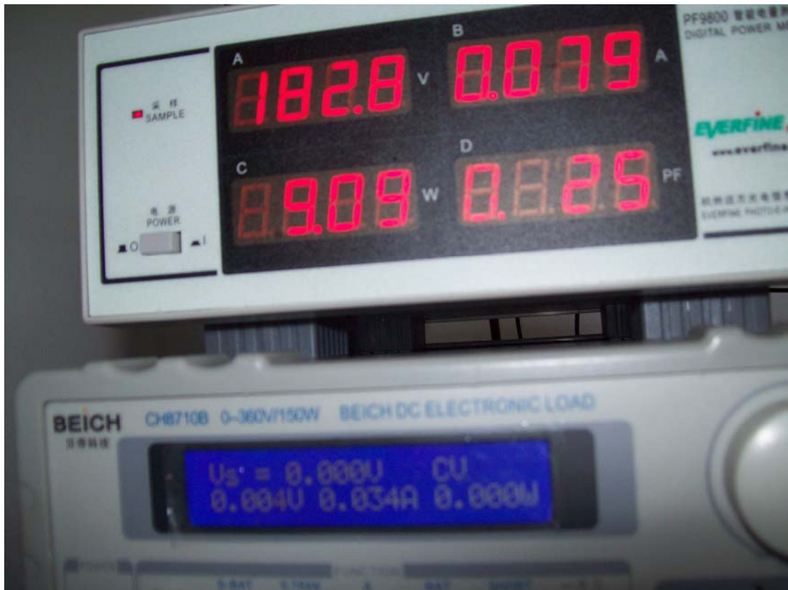
图三：182V 交流输入后恒流后电流为 0.034A
