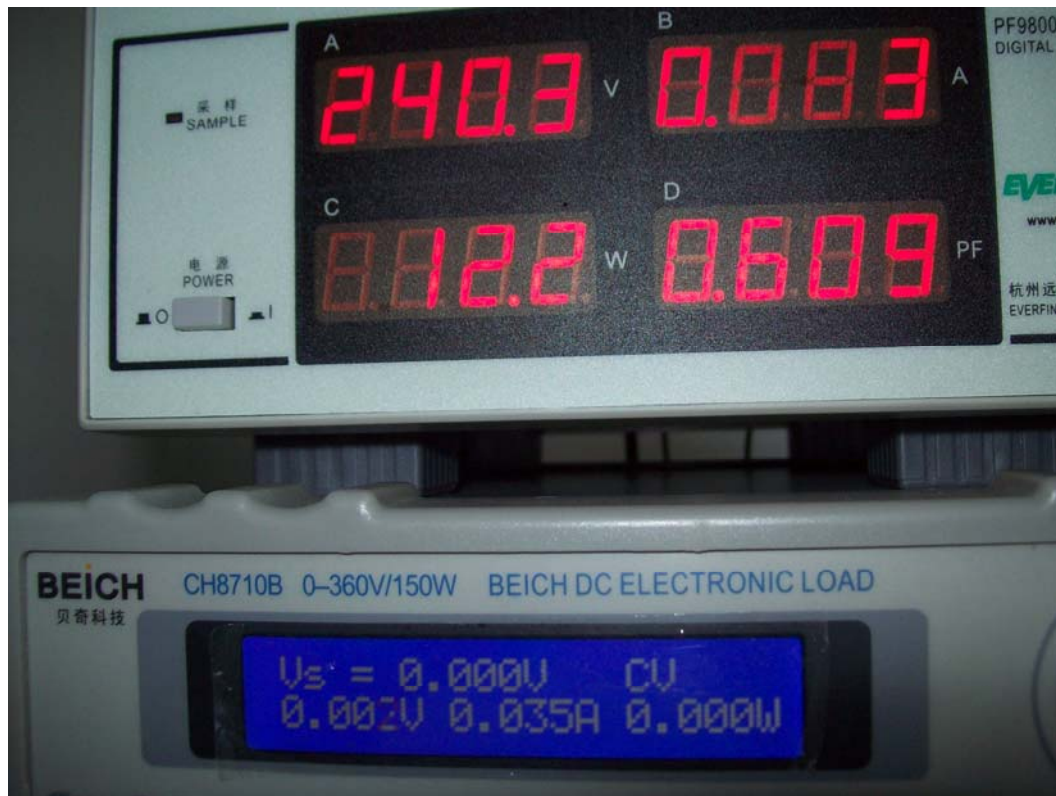
图六：240V 交流输入后恒流后电流为 0.035A
