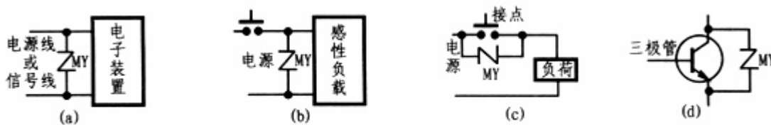
图 1 采用压敏电阻的防护连接
