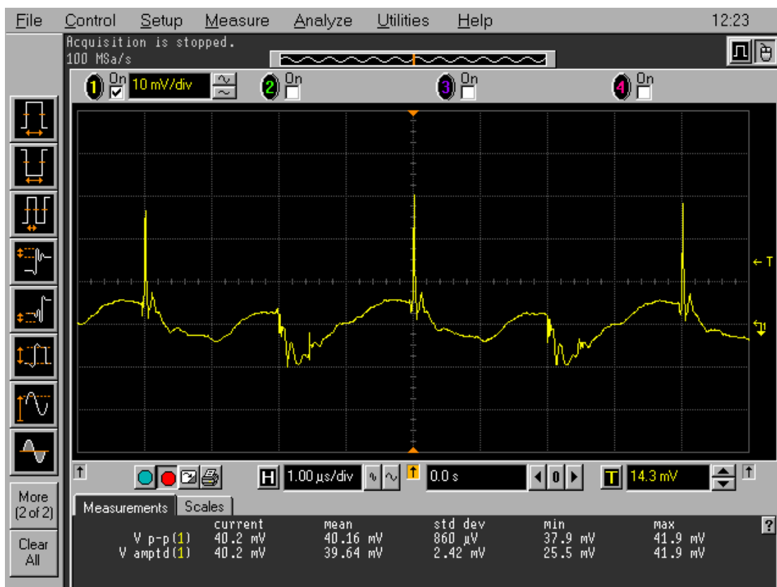
图 3.6 DQ65033QGL10 5.5V 输出纹波
