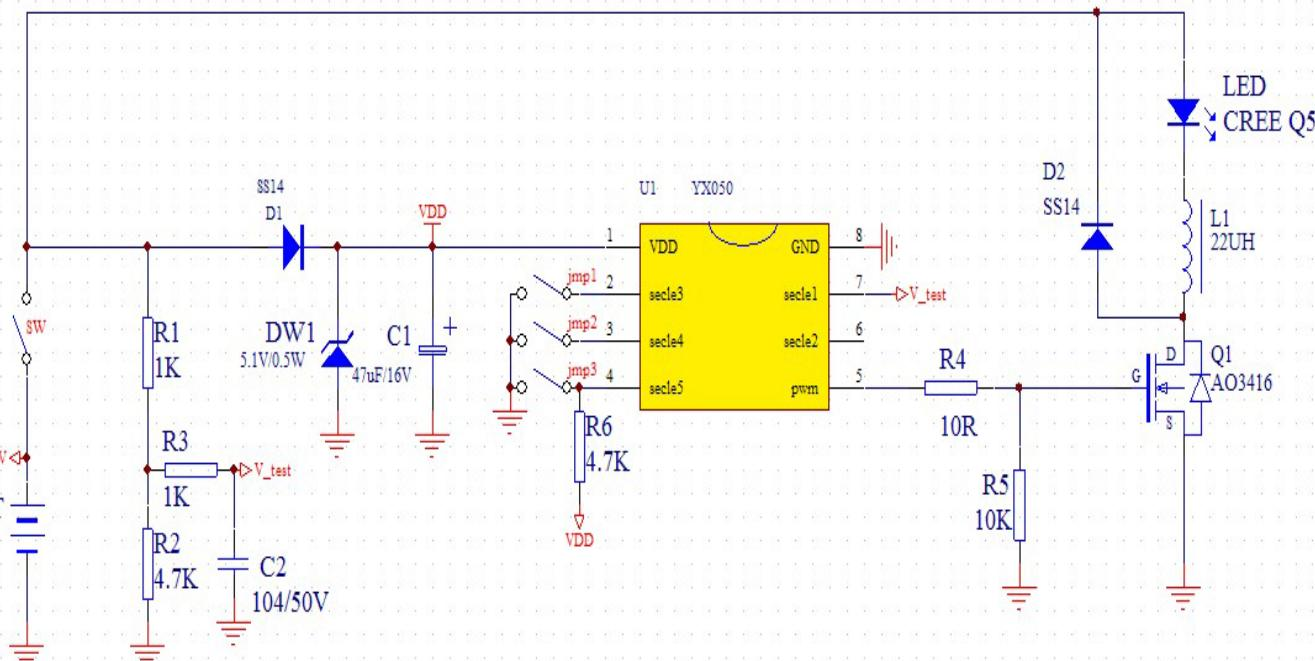
本方案适用于2.5-5.5V电源控制。第一次上电时默认低档工作，在控制PCB空间比较有限的情况下，应用中可省去D2、L1，电阻电容可用贴片0603封装，Q1可使用SOT23封装的AO3416驱动一颗3W左右的LED完全足够。如果需要防反接功能，可在电源部分或开关后面加入SMB封装的肖特基二极管如SS25等。
