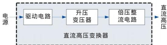
图 2 高频倍压整流高压电源系统
