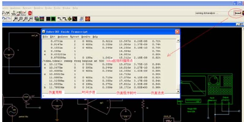
仿真运行以后，点击右上角的 cmd 图标，可以观察仿真程序目前的进度，如上图所示，在仿真进行到 10ms 时，tdsa 启动，开始扫描第一个频点 500Hz。
