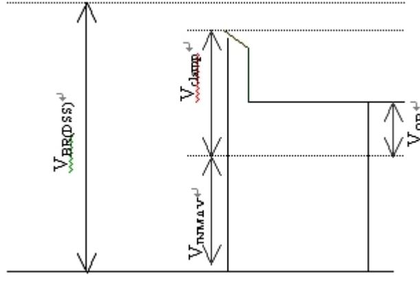
由图可见, 箝位电压 $V_{clamp}$ 与开关管的 $V_{BR(DSS)}$ 及输入最高电压有关, 如果考虑0.9的降额使用系数, 可用下式来确定 $V_{clamp}$ 的大小
