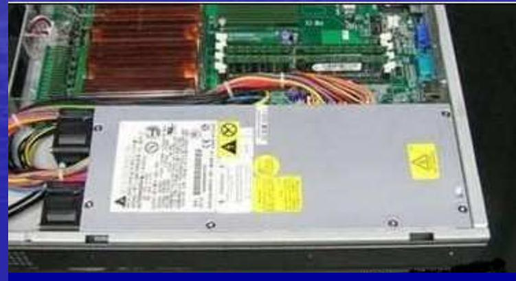
安装在机架中的1U电源
