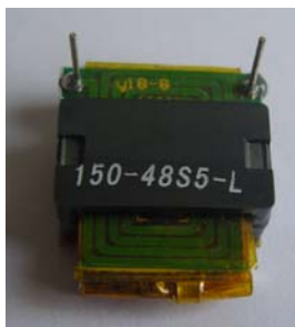
PCB+铜片 (或 PCB+PCB)
