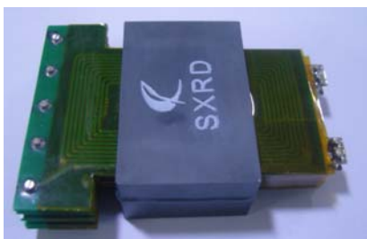
PCB+PCB (或 PCB+铜片)
