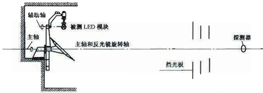
图 A.5 中心旋转反光镜式分布光度计示意图
