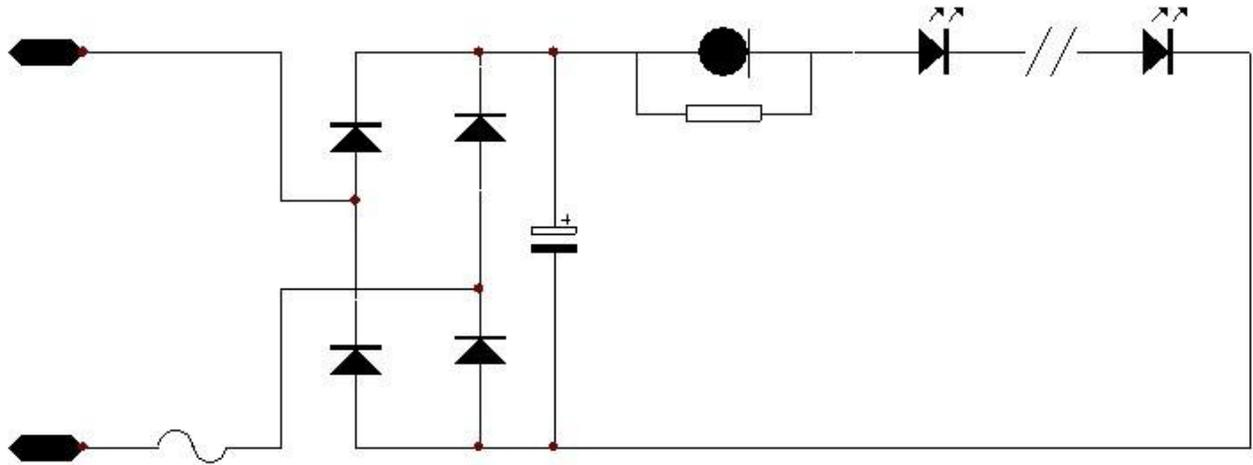
并电阻可以稍微一下恒定电流，但阻值一般不低于 10K 为好，具体可按电流参数调整。
