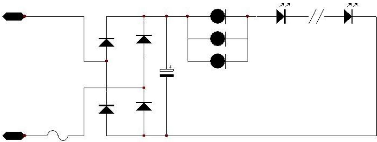
图中如采用 3 颗 203 并联时，则输出电流为  $20\text{MA} \times 3 = 60\text{MA}$ 。但需注意两颗恒流二极管之间的距离不可太近。
