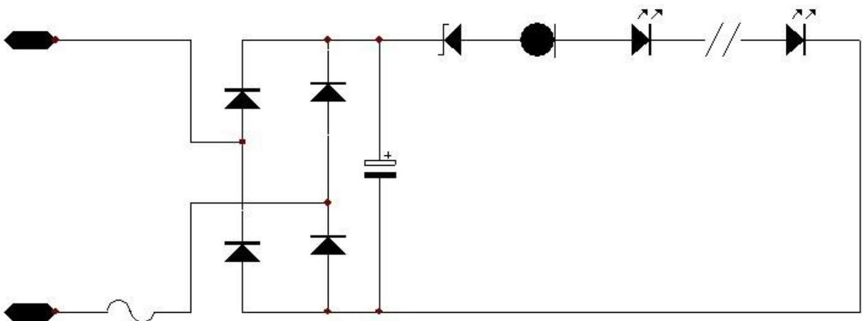
图中如剩余电压为 15V，则串 15V 的稳压管以使 CRD 工作在最佳状态（韩国 CRD 系列的为 6---12V，一般取中间值）。
