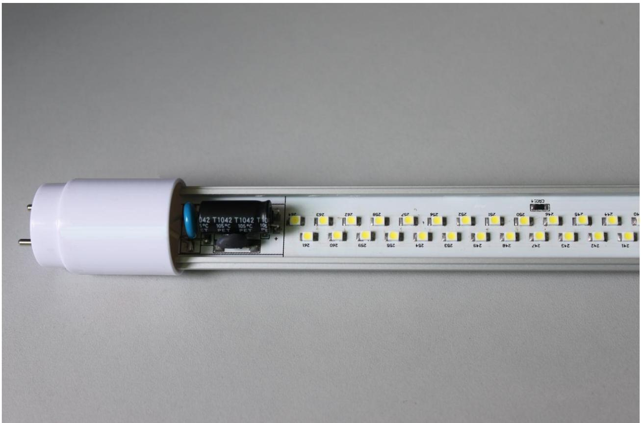
图片显示采用恒流二极管 203 做的日光灯两端的整流滤波部分
