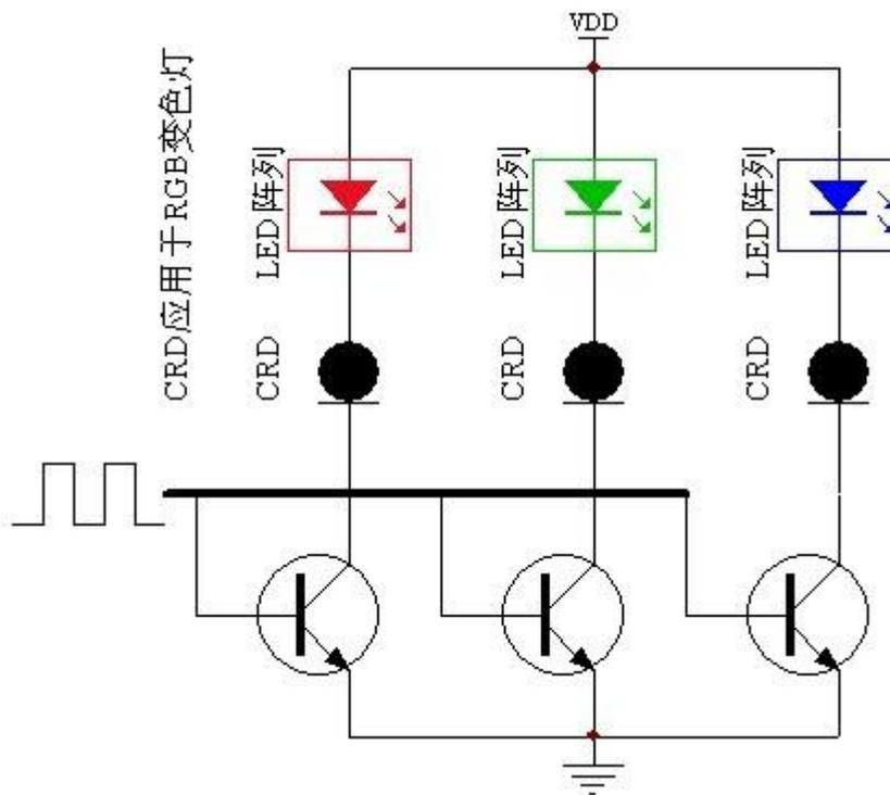
**备注：**采用 CRD 即可恒定每串相同电流，消除采用稳压管串联产生的电流不均匀现象及因输入电压升高而引起的电流上升现象。
