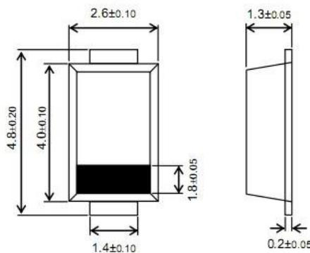
备注：韩国 CRD 系列采用独特的引脚封装结构，内部芯片与管脚的接触不是采用一般的引线接触而是采用独特的面接触类型，独特的引脚结构和内部设计比常规的引线粘结封装具有更好的防浪涌电流能力，适合瞬态抑制应用，正因为这样的封装，所以韩国 CRD 系列的散热、允许最大功率和安全性都比同类产品要好。
