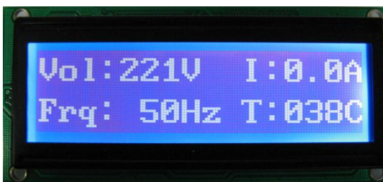
图 8.8c EG8010 连接 12832 工作时液晶屏显示信息
