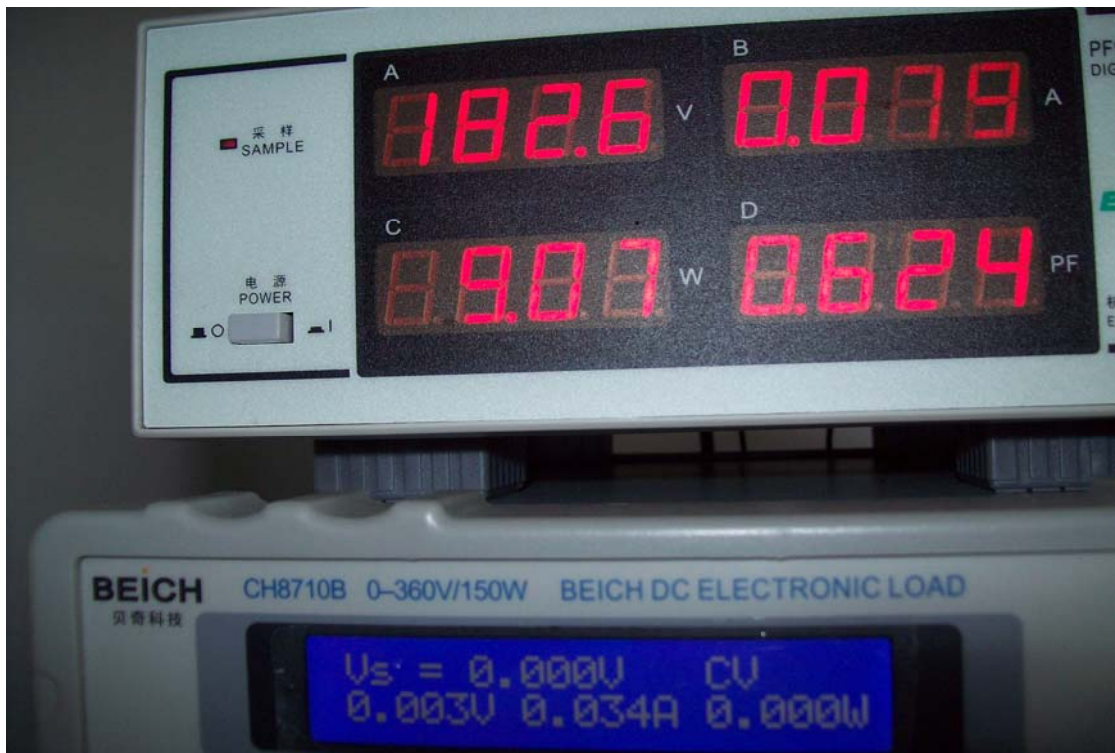
图三：182V 交流输入后恒流后电流为 0.034A
