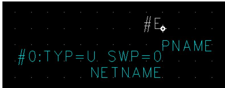
**注意:** 管脚类型(Pin Types)和门可交换(Gate Swap)的值仅仅显示在 CAE 封装(CAE Decal)编辑器中, 而在原理图中不显示。
