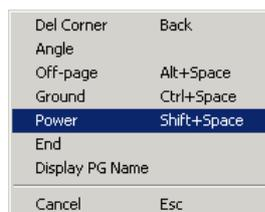
5. 为了连接 U3 的 15 脚到+12V，您必须循环各种各样的电源符号，直到您希望的+12V 符号出现。连接到电源的网络名称将出现在状态条(Status Bar)的左
