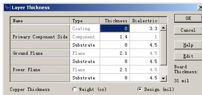
10. 选择 OK，关闭层厚度(Layer Thickness)对话框。
