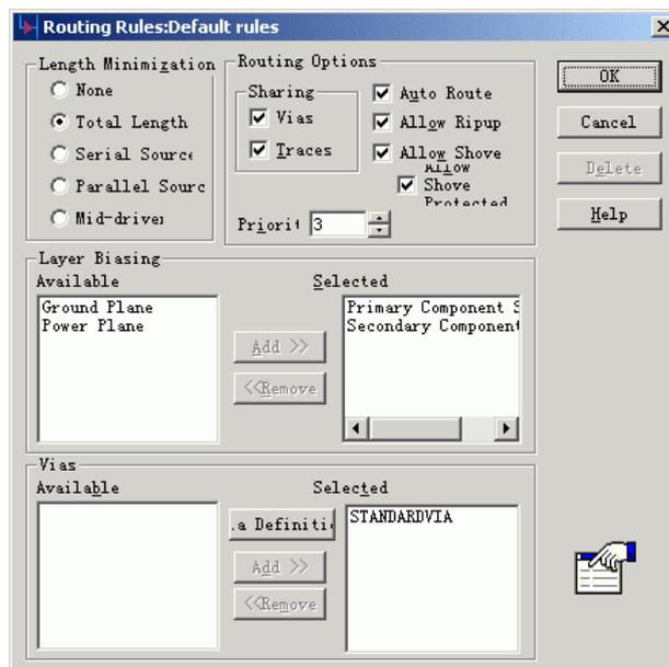
2. 选择电源平面(Power Plane)和地线(Ground Plane)层，并且选择移开(Remove)，以便定义在这些平面层(Plane Layers)上不进行布线。
