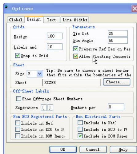
2. 这时，在原理图中便可以进行悬浮方式的连线了。需要停止连续时，双击鼠标左键即可。
