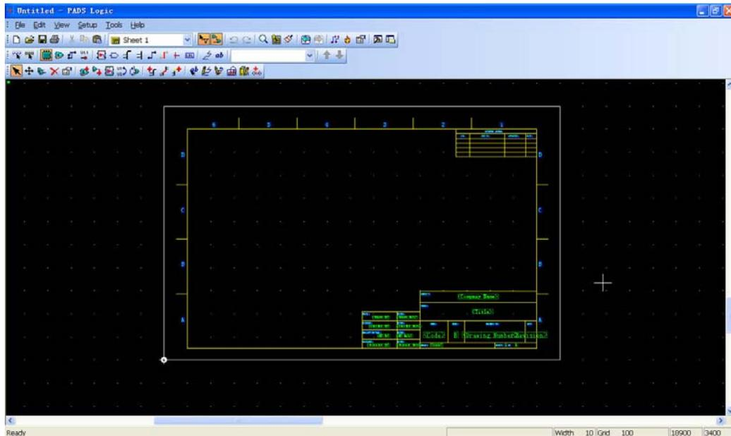
当您光标(Cursor)在工作区域内移动时，它所在位置的 X/Y 绝对坐标值将动态地显示在屏幕底部的状态条(Status Bar)内。
