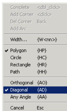
3. 在任意点点击鼠标左键, 开始绘制二维图, 在需拐角的地方点击鼠标左键, 当多边形绘制完成回到起点时双击鼠标左键自动结束绘制。
