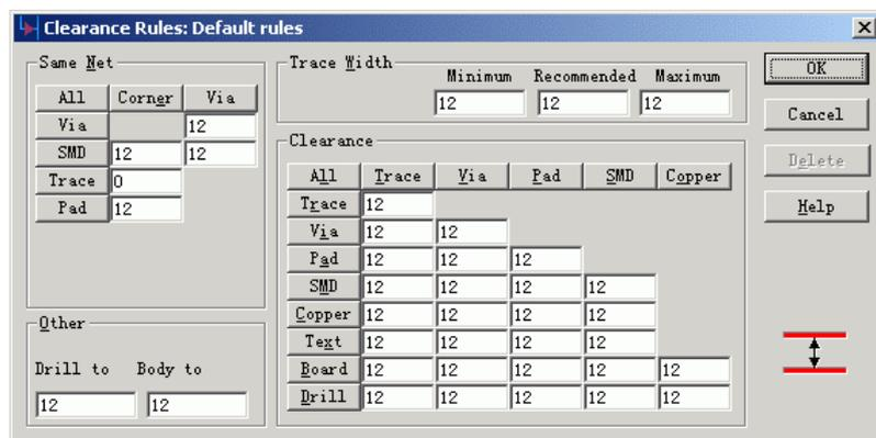
5. 通过选择在安全间距(Clearance) 矩阵左上角的所有(All)框
