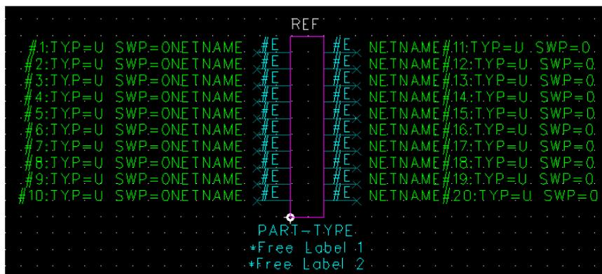
您现在已经开始进行 CAE 封装(CAE Decal)了。这个过程与逻辑符号(Logic Symbols)的管脚符号(Pin Symbols)和添加端点(Terminal)(在管脚封装(Pin Decal)的结尾处有一个小的 X)到 CAE 封装(CAE Decal)。参阅在线帮助(On-line Help)以便得到有关端点(Terminal)和管脚符号(Pin Symbols)之间关系更加详细的信息。
