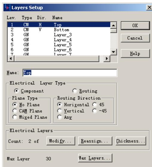
2. 从对话框的电子层(Electrical Layers)区域，通过选择修改(Modify...)，修改层数。
