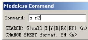
5. 将添加连线(Add Connection)方式有效, 选择 R2 的 2 脚; 一个连线将粘在光标上。
