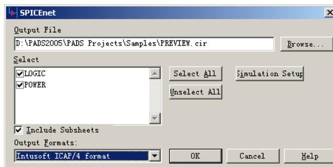
2. 在输出格式(Output Formats)中, 您可以选择以下三种格式:
