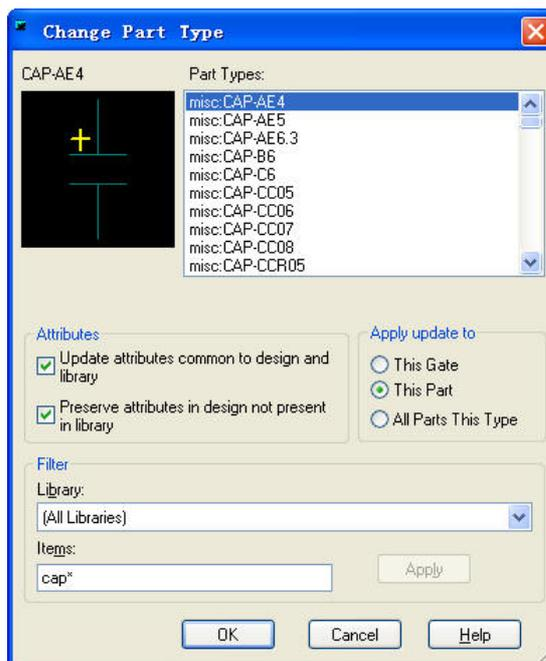
5. 在过滤器(Filter)区域的项目区域内键入 cap\*。选择应用(Apply)。在改变类型(Change Type)对话框内的元件类型(Part Types)列表中所有库内有效的电容将出现。
