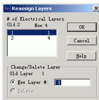
4. 选择 OK，关闭重新指定层(Reassign Layers)对话框。
