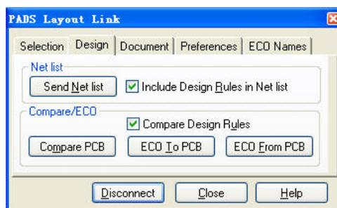
2. 选择传送网表(Send Netlist)按钮, 自动地从 PADS Logic 中输出一个网表(Netlist), 并将网表(Netlist)送出, 通过 PADS-Layout 的 OLE 功能, PADS-Layout 将网表(Netlist)(或 ASCII)输入。
