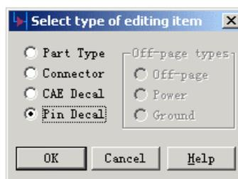
一旦您进入管脚封装编辑器(Pin Decal Editor), 有几个字符标号和管脚封装(Pin Decal)原点标记将出现。各个字符标号放在与管脚有关的字符目标上。一旦您将这些标记放在管脚封装(Pin Decal)中, 这些管脚目标字符将出现在 CAE 封装(CAE Decal)上。原点标记有两个用途, 一是连线连接的点, 另一个是移动或放置管脚封装(Pin Decal)的原点。
