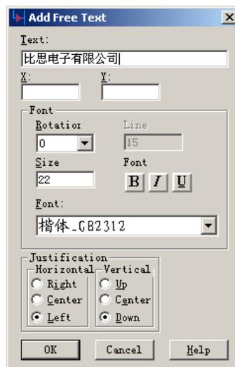
8. 在 Text 输入框中输入文本，设置字体大小(Size)、字体加粗、斜体等等，Font 对话框中对字体类型进行设置。
