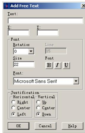
2. Text 输入框中输入文本，X 框中输入 X 坐标，Y 框中输入 Y 坐标，Font 对话框中对字体旋转、字体大小、字体类型等的设置。
