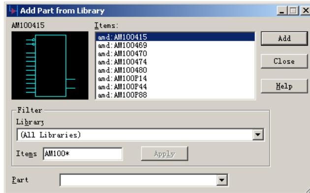
c. 在添加元件(Add Part)对话框中，键入 AM100\*，这将告诉 PADS Logic 在库中搜索以“AM100”四个字符开头所有元件，并且在元件列表框中显示。
