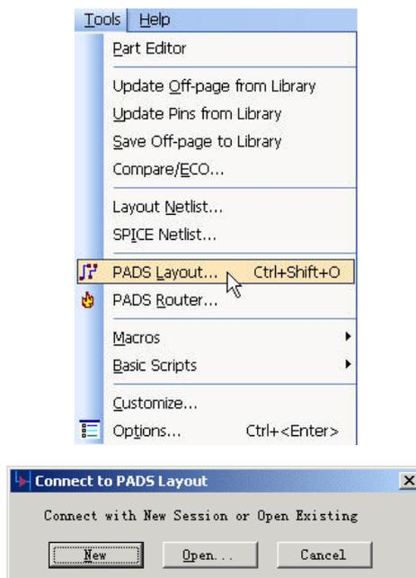
2. 选择新的(New), 以便开始一个新的 PADS-Layout 窗口。这将使 PADS-Layout 启动, OLE 连接 PADS-Layout 对话框出现。
