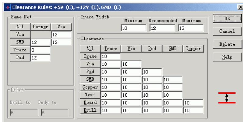
5. 通过选择在安全间距(Clearance) 矩阵左上角的所有(All)框，设置全局的缺省的安全间距(Clearance)值。输入安全间距(Input Clearance Value)对话框将出现。
