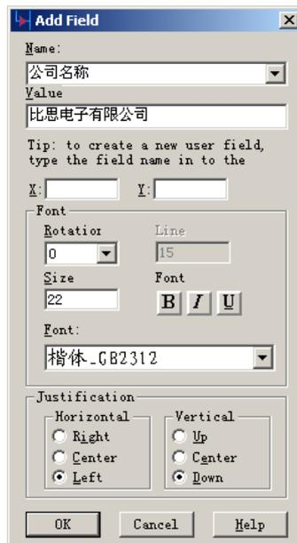
4. 选择原理图第二页, 选择工具条中添加变量文本 (Add Field) 按钮
