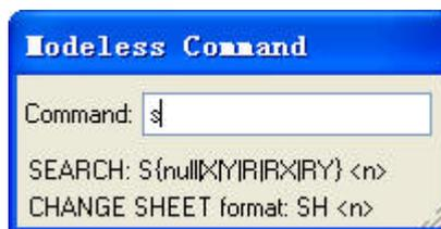
标准的 Windows 快捷键，如 Alt-F 用于显示文件菜单等命令，在 PADS Logic 中同样有效。关于具体的无模命令可打开帮助菜单(Help)下的 Modeless Commands 选项进行查看。
