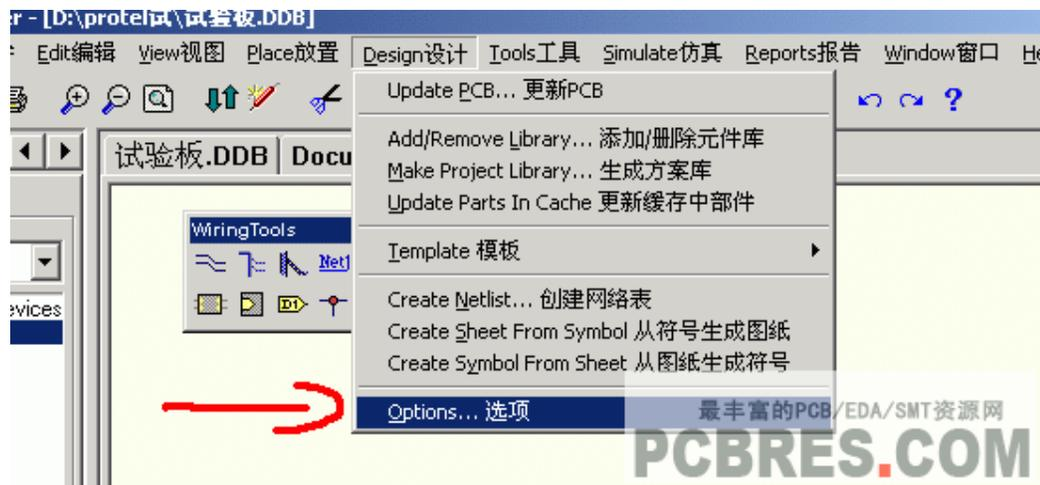
protel99se 的原理图高级技巧二:设置 protel99se 原理图的工作页面,我们可以对照下边,对 SCH 环境进行设置
