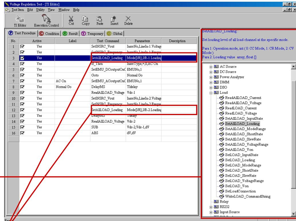
測試命令庫防止重復下命令給硬件設備；因而可以提高測試速度。
