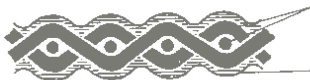
图 7.1 在编织好的织物上进行导电涂覆
