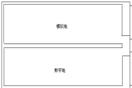
布局时将数字电路和模拟电路分开，器件排列尽量紧凑，布线时避免数字电路的信号跨越模拟电路区域，避免模拟电路的信号跨越数字电路区域。两个区域隔离足够的距离。数字地与模拟地分割，然后在插座处单点连接，见左图。这样能最大限度地抑制数字电路对模拟电路的干扰。
