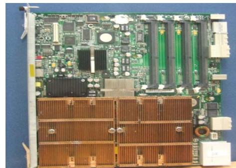
80W 热管散热器，采用均温排布及翅片优化技术
