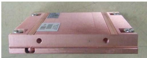
友商HP在其高性能服务器上所采用的热管散热器
