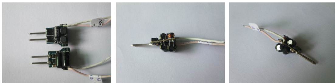
图3 适应所有电子变压器的MR16 3*1W电源
