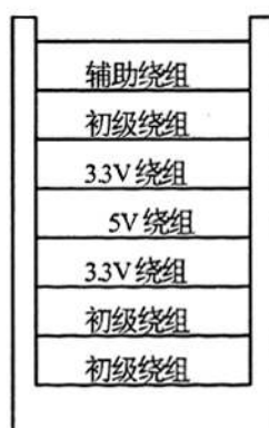
图5-3 样机变压器绕制结构图
