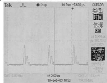
f) \Delta V\% = 0 时非受控组电流波形图
