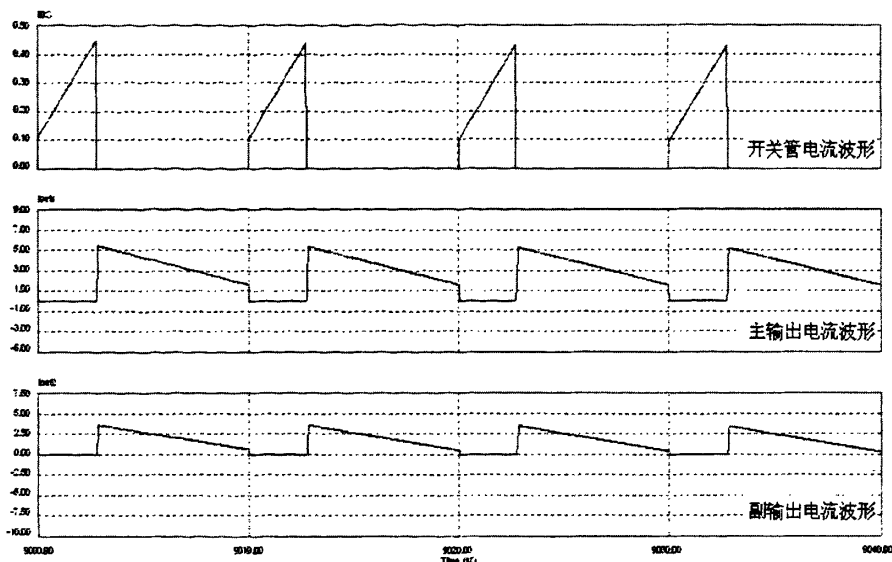
b) 励磁电感量为180uH时的相关波形
