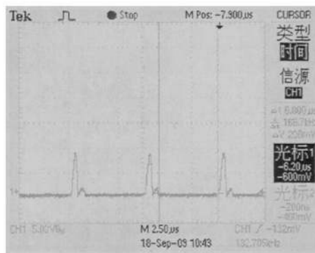
b) \Delta V\% = 14\% 时非受控组电流波形图
