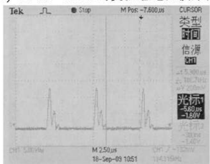
e) \Delta V\% = 0 时受控组电流波形图
