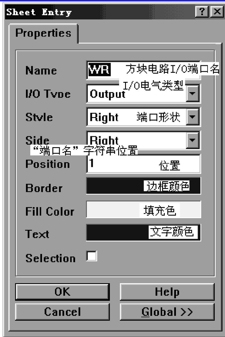
电源网 笨小孩1114 图3-10 方块电路I/O端口属性设置窗
