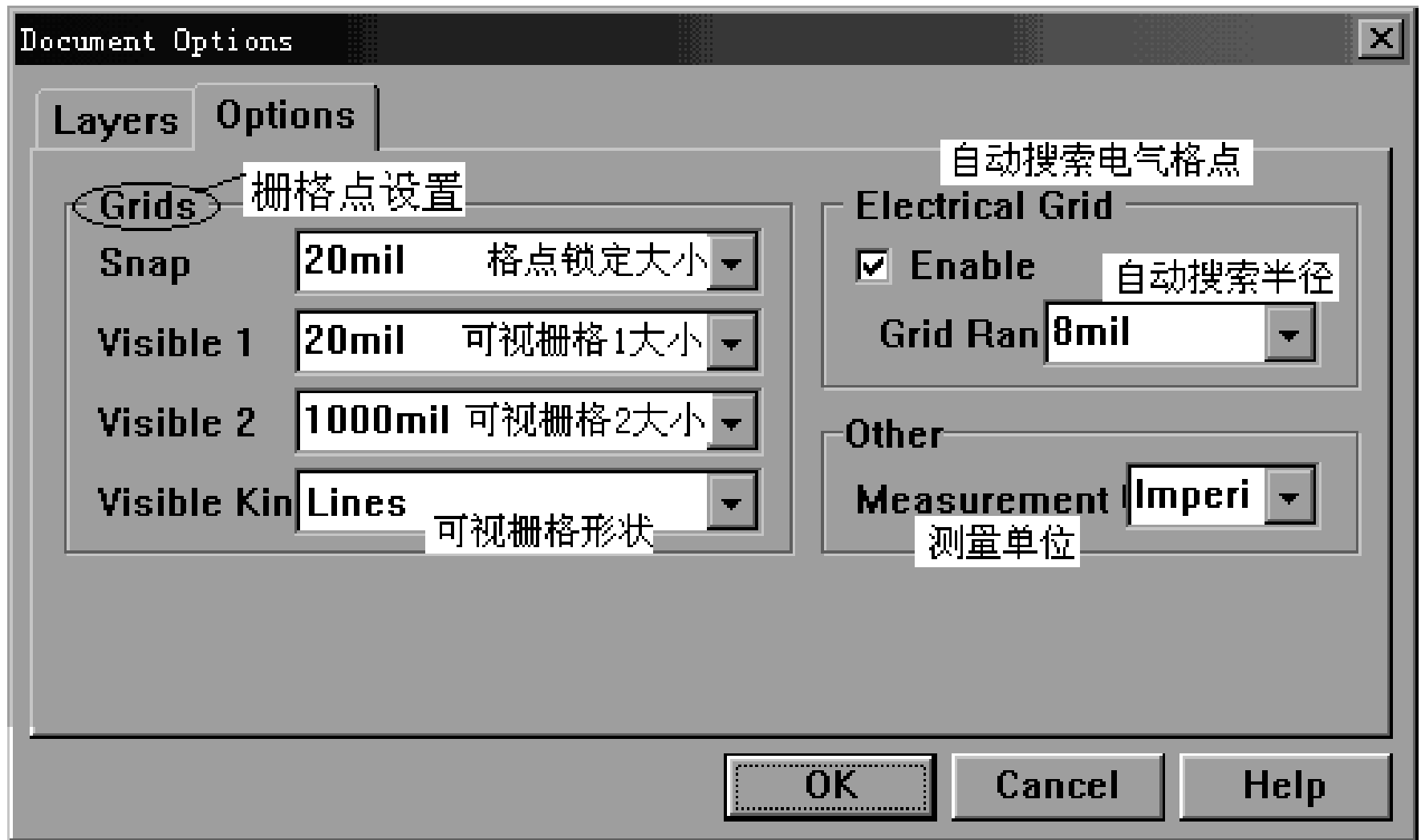
图5-6 设置PCB编辑区可视格点大小
