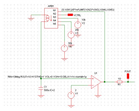
添加两个模块端子 VCTRL,FOUT (按 H 键可以添加模块端子)
