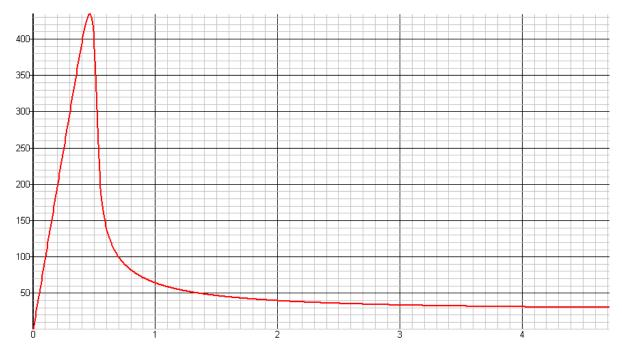
曲线表示了 V1 从 0V 到 5V, Q1 C 极对应的电压
