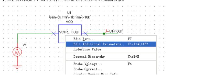
参数设置如下,Gain 设置为 5k,表示输入 1V 输出就是 5K 的频率。Fmin 设为 4k,Fmax 设为 20k,表示最小输出频率为 4k,最大输出频率为 20k.
