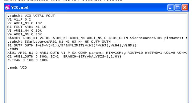
为了可以实现输入参数,我们要把 VCO.MOD 稍作修改,把影响这些的值修改为变量在第一行最后加入 params: Gain=10k Fmin=20k Fmax=50k (表示默认 1V 对应 10K 频率,最小频率 20K,最大频率 50K)
