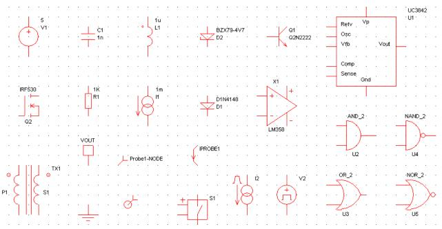
基本的元件如 DC 电源,波形发生器电源,分段源,受控源,电阻,电容,电感,变压器,MOS 管,三极管,二级管,稳压管,压控开关,地,电压探头,电流探头,运放等都能找的到,如上图,也可以从 Place——From Model Library 菜单中找到更多的元件,如 3842,TL431 等。
