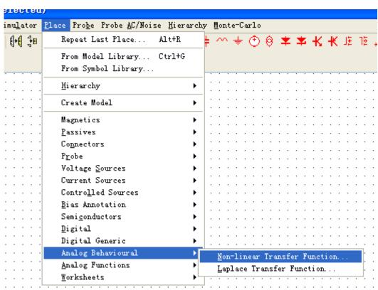
在里面设置两组电压输入,一路电流输出,如下图 并在框里输入 V(N2)/V(N1).表示输出电流等于 V2 上的电压除以大电解上的电压
