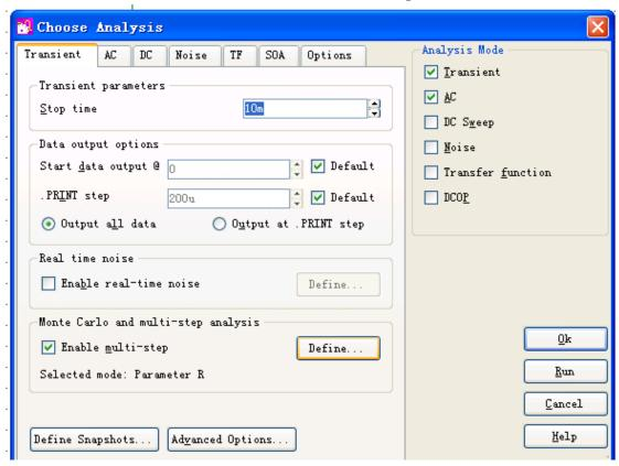
在弹出的框框里面选择第 2 项: Parameter 然后设置数据 start value:1k,stop value:10k, Number of steps:10, Parameter name:R 如下图。点 OK。
